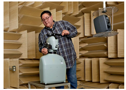
戈尔声学消音室内进行的声学测试
